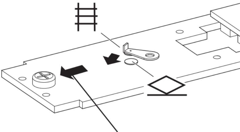
Gehäuse-Einbaurichtung Führerstand 1
